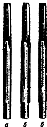
Р и с. 12. Метчики а, б — предварительная (рабочая) нарезка, а — чистовая
