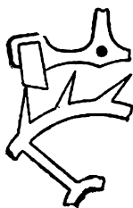
Рис. 106. Анкерное колесо с острыми зубцами (английское)
