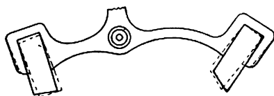
Рис. 114. Изменение угла притяжки
