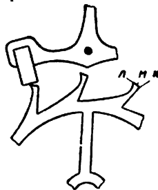
Рис. 108. Анкерное колесо с зубцами особой формы: к — вершина зубца; л — пятка зубца; м — плоскость импульса
